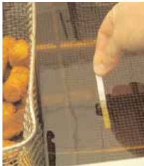
图22：使用检测试纸，测量游离脂肪酸
