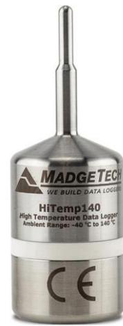
HiTemp140是一款坚固耐用的高精度温度数据记录仪，专为恶劣环境而设计这款不锈钢设备可潜水，可承受高达140°C（284°F）的温度。通过HiTemp140的标准校准，可以在宽温度范围内实现±0.1°C（±0.18°F）
