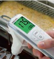
4. 轻轻搅动探头后，等待直到显示屏上显示Auto Hold，仪器自动保持读数，显示颜色变亮
