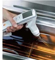
1. 将炸物取出，等待约5分钟以上，待油槽内无气泡冒出开始测量
