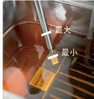
3. 将探头垂直浸入至油槽中心位置的热油中，浸入深度在最小/最大标志间
